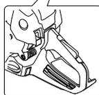
Da die Kettenbremse immer noch eingeschaltet ist, muss die Motordrehzahl so schnell wie möglich auf Leerlauf herunter, was durch ein schnelles Ausschalten der Gassperre erreicht wird. Dadurch vermeiden Sie
