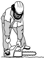
Halten Sie die Motorsäge mit festem Griff, in dem Sie die Handgriffe fest mit Daumen und Fingern umschließen.
