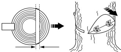
Man verliert völlig die Kontrolle über die Fallrichtung des Baumes, wenn das Brechmaß zu klein oder durchgesägt ist oder wenn Kerb- und Fällschnitt an falscher Stelle ausgeführt wurden.
