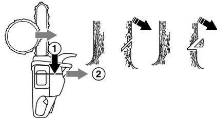
Die Schnitttiefe der Kerbe soll etwa 1/4 des Stammdurchmessers und der Winkel zwischen dem oberen und unteren Schnitt mindestens 45° betragen.
