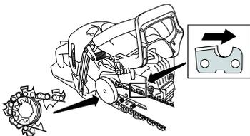
Darauf achten, dass die Schneiden der Sägezähne auf der Schienenoberseite nach vorn gerichtet sind.
