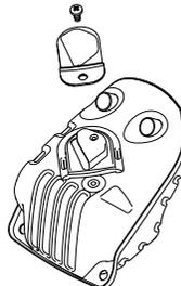
Der Schalldämpfer hat die Aufgabe, den Schallpegel zu dämpfen und die Abgase vom Anwender wegzuleiten. Die Abgase sind heiß und können Funken enthalten, die einen Brand verursachen können, wenn die Abgase auf trockenes und brennbares Material gerichtet werden.
