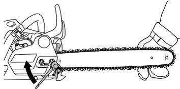
An einer neuen Kette muss die Kettenspannung oft kontrolliert werden, bis die Kette eingefahren ist. Die Kettenspannung regelmäßig prüfen. Mit einer richtig gespannten Kette wird eine gute Schnittleistung und eine lange Lebensdauer erzielt.
