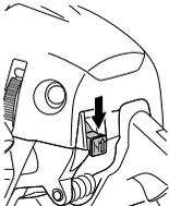
**ACHTUNG!** Der Start/Stopschalter geht automatisch in die Betriebsposition zurück. Um ein ungewolltes Starten zu vermeiden, muss bei Montage, Kontrolle und/oder Wartung daher stets die Zündkappe von der Zündkerze entfernt werden.
