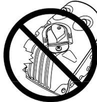
Regelmäßig kontrollieren, ob der Schalldämpfer fest am Gerät montiert ist.
