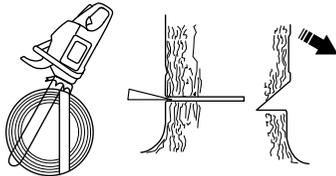
Der Fällschnitt soll parallel zur Kerbschnittlinie abschließen, so dass der Abstand zwischen beiden Schnitten mindestens  $\frac{1}{10}$  des Stammdurchmessers beträgt. Der nicht durchgesägte Teil des Stamm wird als Brechmaß bezeichnet.
