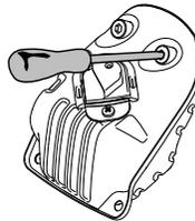
Bestimmte Schalldämpfer sind mit einem speziellen Funkenfangnetz ausgerüstet. Ist Ihr Gerät mit einem derartigen Schalldämpfer ausgestattet, so ist das Netz einmal wöchentlich zu säubern. Dies geschieht am besten mit einer Stahlbürste. Bei Verstopfung des Netzes läuft der Motor heiß, was schwere Motorschäden zur Folge haben kann.
