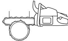
Es gibt Methoden zum Fällen von Bäumen, deren Stammdurchmesser größer ist als die Führungsschielenlänge. Bei solchen Methoden besteht große Gefahr, dass der Rückschlagbereich der Führungsschiene mit einem Gegenstand in Berührung kommt.
