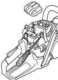
Bei Temperaturen unter -5 °C und/oder Schnee kann auf dem Startvorrichtungsgehäuse eine spezielle Abdeckung montiert werden.
