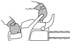
Geben Sie Vollgas und betätigen Sie die Kettenbremse, in dem Sie das linke Handgelenk gegen den Handschutz
