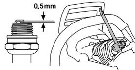
Hinweis! Stets den vom Hersteller empfohlenen Zündkerzentyp verwenden! Eine ungeeignete Zündkerze kann Kolben und Zylinder zerstören. Dafür sorgen, dass die Zündkerze eine sog. Funkentstörung hat.
