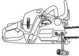
Die Kette ist richtig gespannt, wenn sie an der Schienenunterseite nicht durchhängt und noch leicht von Hand durchgezogen werden kann. Die Schienenspitze anheben und dabei gleichzeitig die Schienenmuttern mit dem Kombischlüssel festschrauben.
