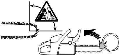
Das Sägen mit der Unterseite der Führungsschiene, d.h. von der Oberseite des Baumstammes nach unten, wird als Sägen mit ziehender Kette bezeichnet. Die Motorsäge wird zum Baumstamm hingezogen und die Vorderkante des Motorsägenkörpers fungiert als natürliche Stütze am Stamm. Beim Sägen mit ziehender Kette hat der Anwender eine bessere
